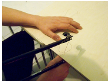
Abb. (28): Der Bumerang wird mit wird mit einer Laubsäge ausgeschnitten
