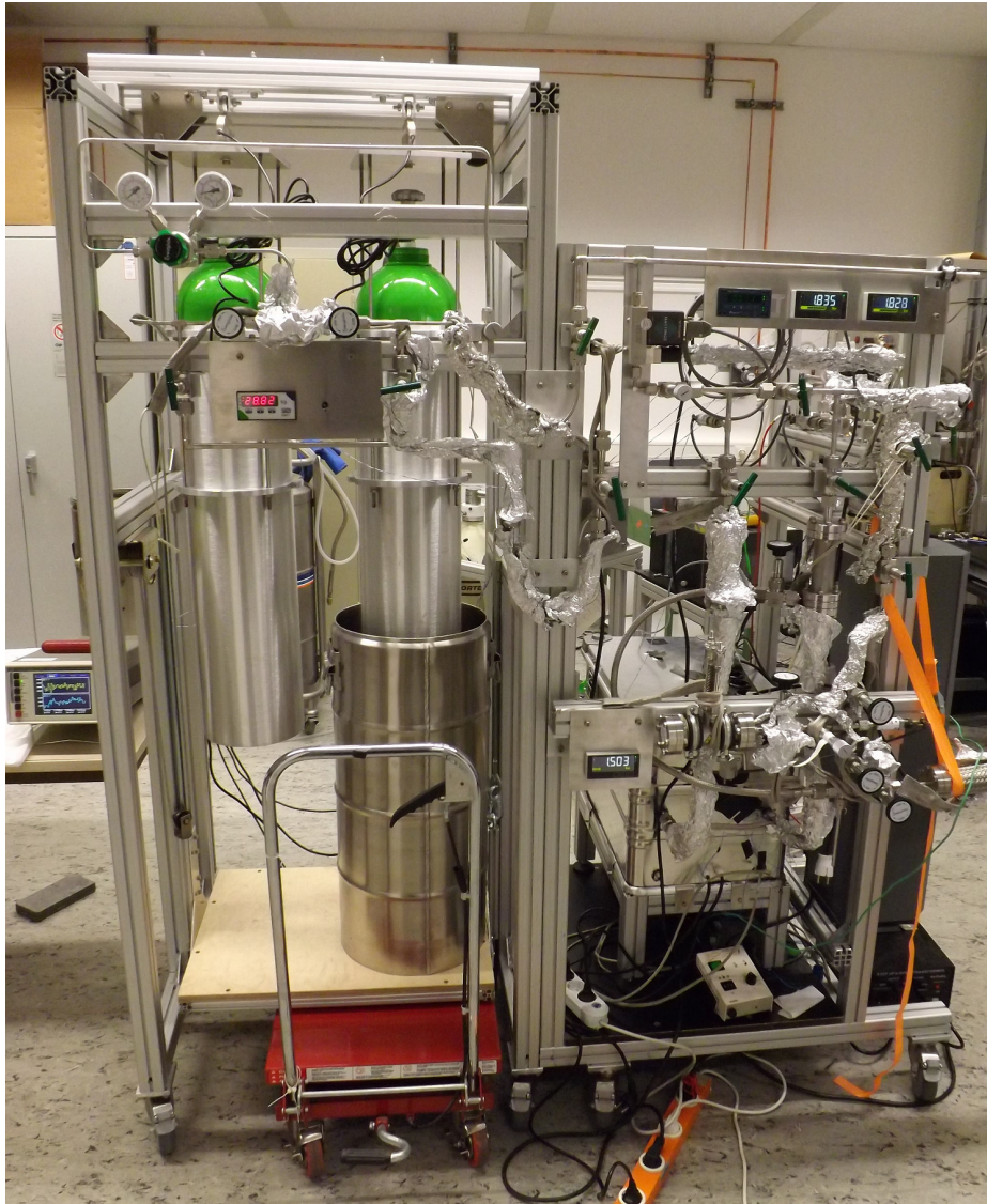
Abbildung 8.8: Foto des Gassystems. Auf der linken Seite ist der Lagerteil mit den Gasflaschen zu sehen. Auf der rechten Seite befindet sich das Rezirkulationssystem. An der Vorderseite ist auf halber Höhe der Kalibrationsgasbehälter mit der Ampullenöffnungsvorrichtung und der Dosieranordnung zu sehen.
