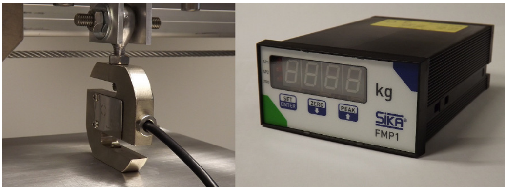
Abbildung 3.11: Die verwendeten Wägezellen vom Typ S40S (links) und das zugehörige Auslesegerät vom Typ FMP1 (rechts).
