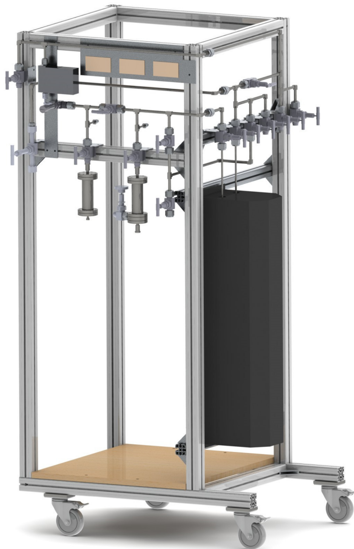
Abbildung 3.1: Gerenderte Darstellung des Gassystems. In der Abbildung ist die verwendete Doppelmembranpumpe nicht abgebildet. Die Bezeichnung der einzelnen Komponenten kann Anhang 8.1 entnommen werden.
