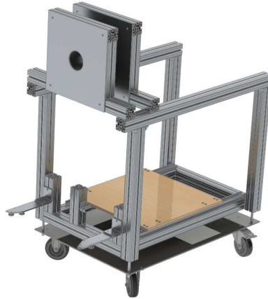
Abbildung 3.1.9.: Profilstangengestell für den Germaniumdetektor.
