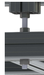
Abbildung 3.1.7.: Anordnung dreier Muttern an einer Profilstange zur Höhenverstellung der Profiltische.
