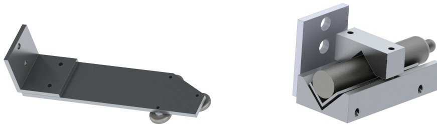
Abbildung 3.1.10.: links: Verbindungsarm zwischen Germaniumdetektortisch und Rundschiene, rechts: Laserhalterung zur Winkeleinstellung.
