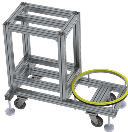
Abbildung 3.1.8.: Kollimatorprofiltisch und Rollplatte mit Sicht auf den Befestigungsring.
