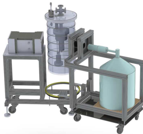
Abbildung 3.1.1.: Gesamter Versuchsaufbau bei einer veränderten Winkeinstellung des Germaniumdetektors im Bezug zur TPC.
