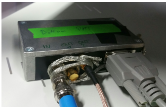
Abbildung 11.: Der Zehnfachverstärker mit dem Schirmgeflecht um die Anschlüsse gewickelt.
