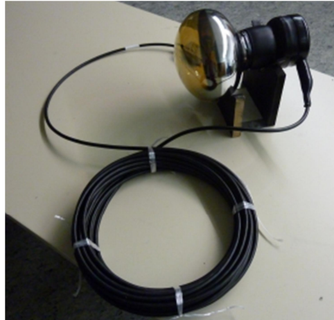
Abbildung 2: Foto des PMT-Modells R5912-ASSY-2 (wasserdichte Variante von R5912); Die zwei Kabel zur Übertragung von Hochspannung und Signal befinden sich in einem wasserdichten Kunststoffschlauch, der aufgewickelt daneben liegt.
