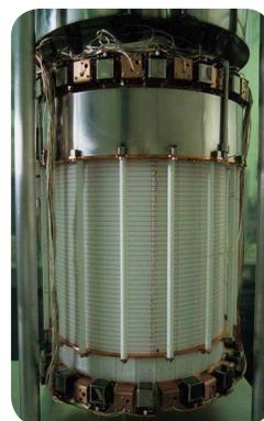
Spurendriftkammer des XENON100-Experiments
